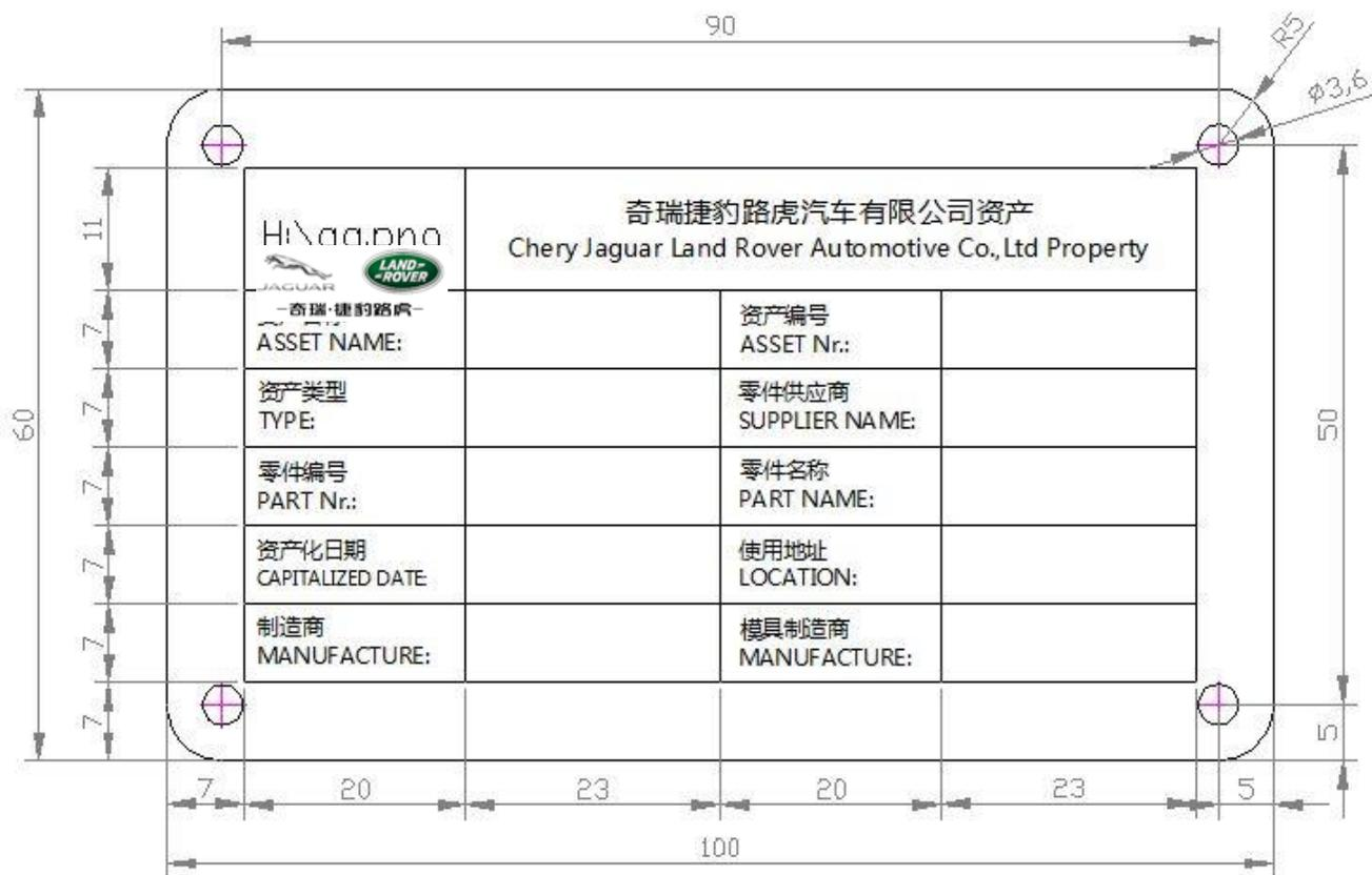
铭牌规格要求：铭牌需严格按照上图示意的规格进行制作，具体模板参考附件AutoCAD文档。
